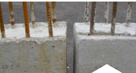
Konventioneller Betonstahl (links) und Top12-500 (rechts)
